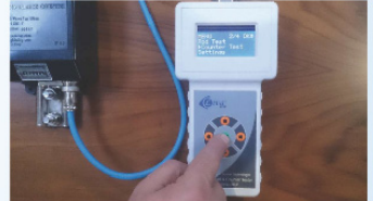
14 Teste devam etmek için cihaz üzerindeki OK. Butonuna basıp bırakınız Press to OK. Button, for to test Lightning Strike Counter
