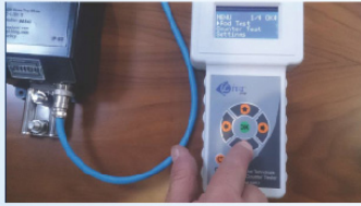
12 Cihaz üzerindeki aşağı tuşuna basıp bırakarak Counter Test satırını seçiniz Press down button for to select Counter Test
