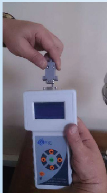
34 Test Kablosunu Paratoner Test Cihazı Soketine bağlayınız Connect the Test Cable to Lightning Rod Tester Test Socket
