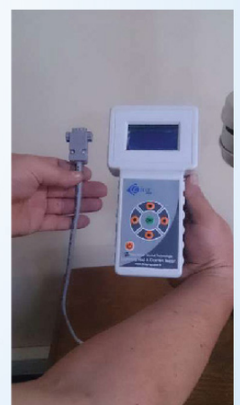
33 Test Kablosunu Paratoner Test Cihazı Soketine bağlayınız Connect the Test Cable to Lightning Rod Tester Test Socket
