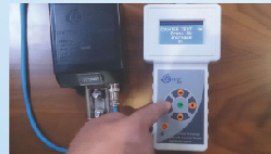
19 Test işlemi bittğinde, Test Cihazı üzerinde buluna SOL OK düğmesine basınız. When the test finished, you must be press Left button
