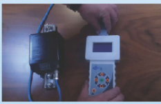
24 Test Cihazının soketinden test kablosunu çıkartınız Remove the Test Cable from Tester socket
