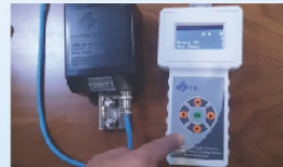
21 Test tamamlandığı için Test Cihazını kapatmak için Güç düğmesine 3 saniye basılı tutunuz Press the power button for power off
