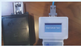
20 Test Cihazının ekranında "Completed Test" yazısını göreceksiniz. You will see "Completed Test" write on the tester display
