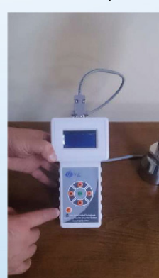
36 Test Cihazını çalıştırmak için 3 saniye basılı tutunuz Press 3 Second the power button for power on
